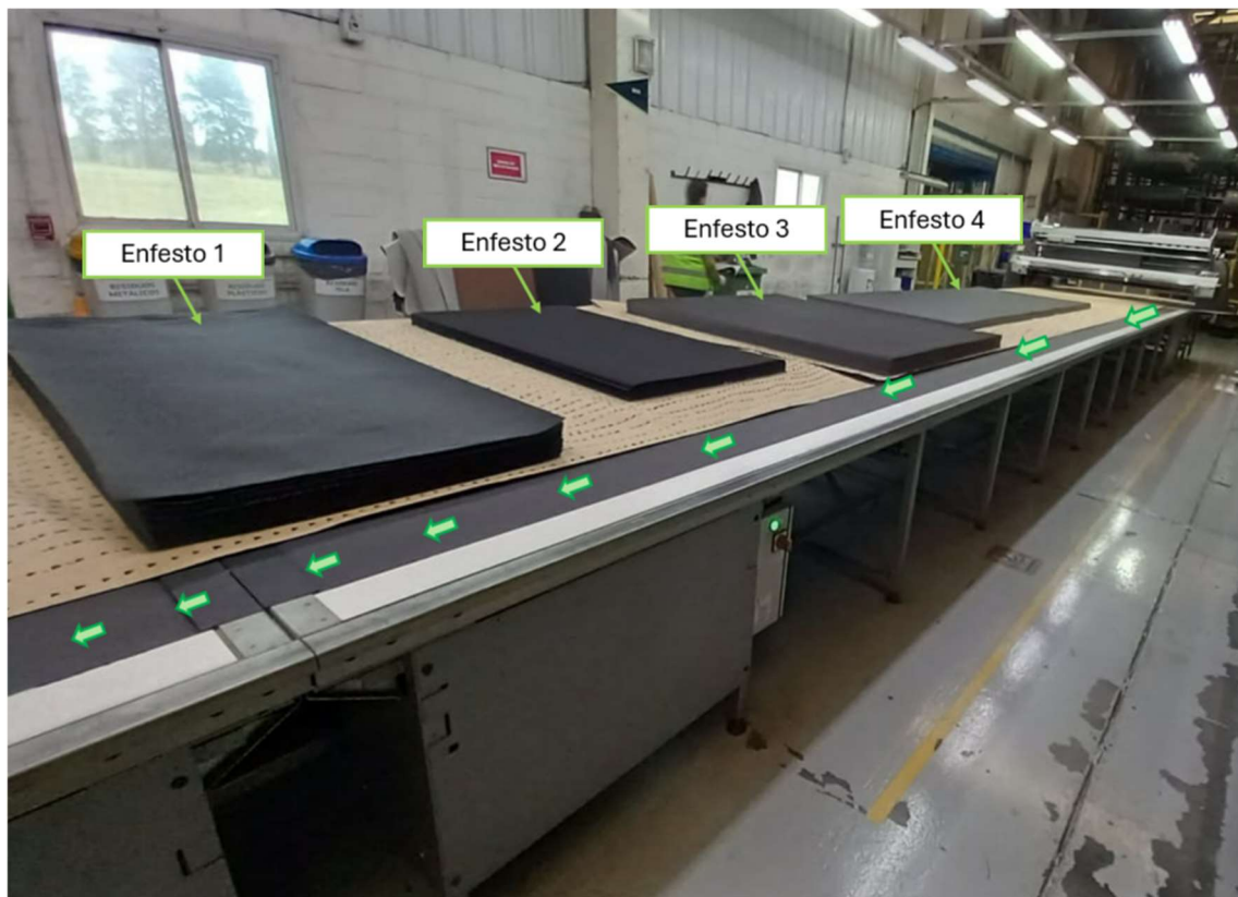
TRANSPORTE DE MATERIAL ENFESTADO NA MESA DE TRANSFERENCIA
