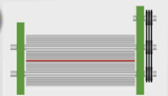
Processador de kernel tipo rolo tradicional
