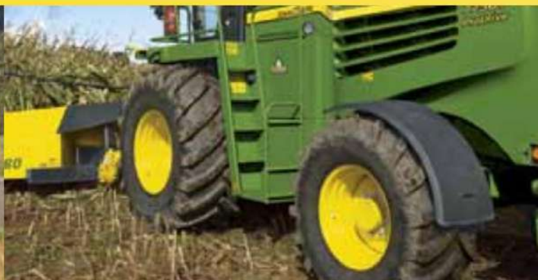
As velocidades independentes dos eixos evitam danos em solos sensíveis durante curvas de cabeceira
