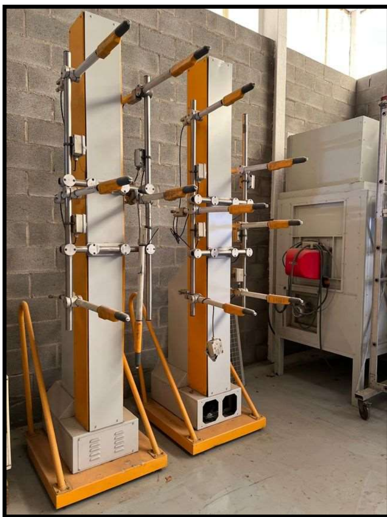
Imagem 02 – Vista ilustrativa das pistolas automáticas de pintura por dispersão eletrostática de pó montadas em uma estrutura.
