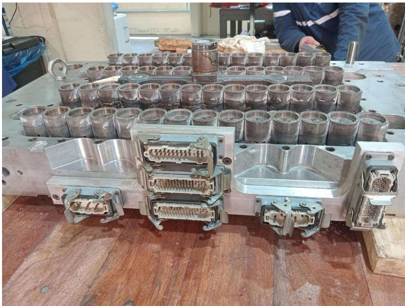
Figura 3 – Componentes do sistema de aquecimento e controle térmico.
