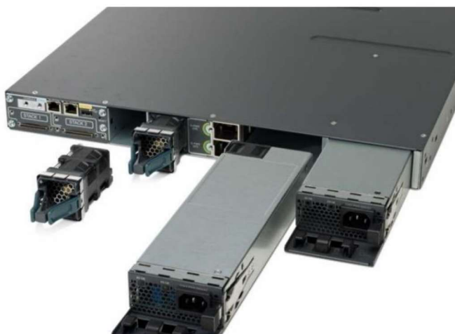
Figura 3. Fontes de alimentação redundantes duplas
