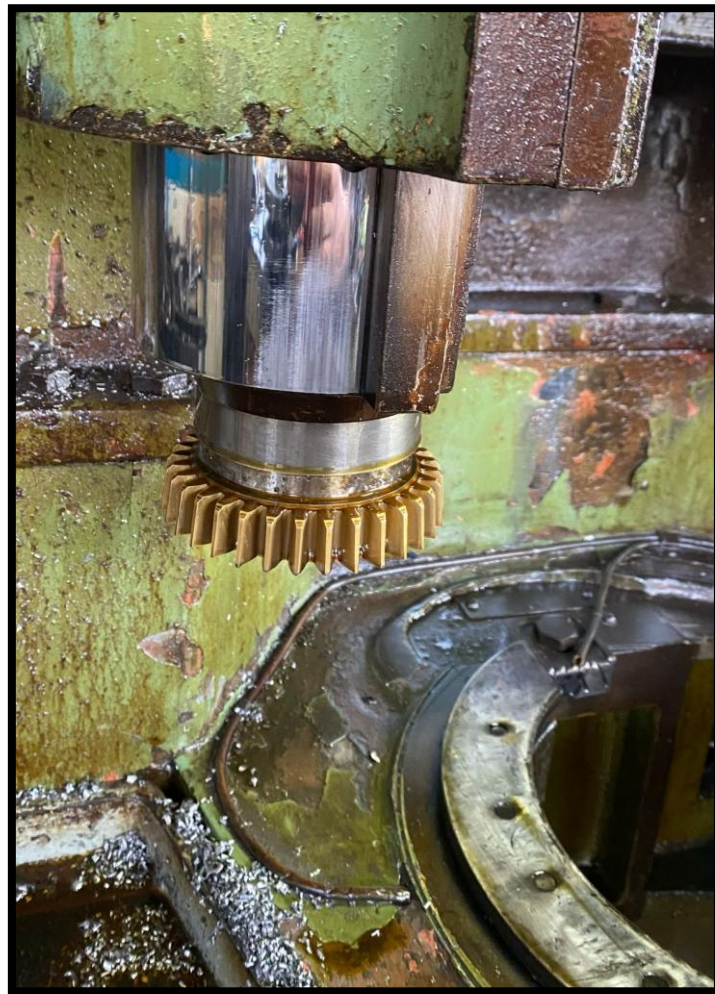
Figura 1 - Detalhe cabeçote porta ferramentas e mesa
