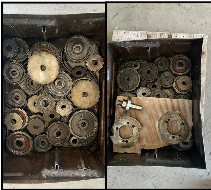
Figura 2 - Peças inclusas e indispensáveis para o uso da máquina engrenagens de regulação de recambio.
