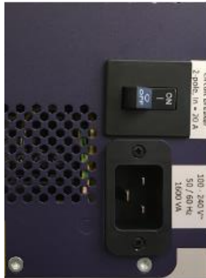
Figura 4 - Plug de alimentação e chave seletora localizados na parte traseira do equipamento
