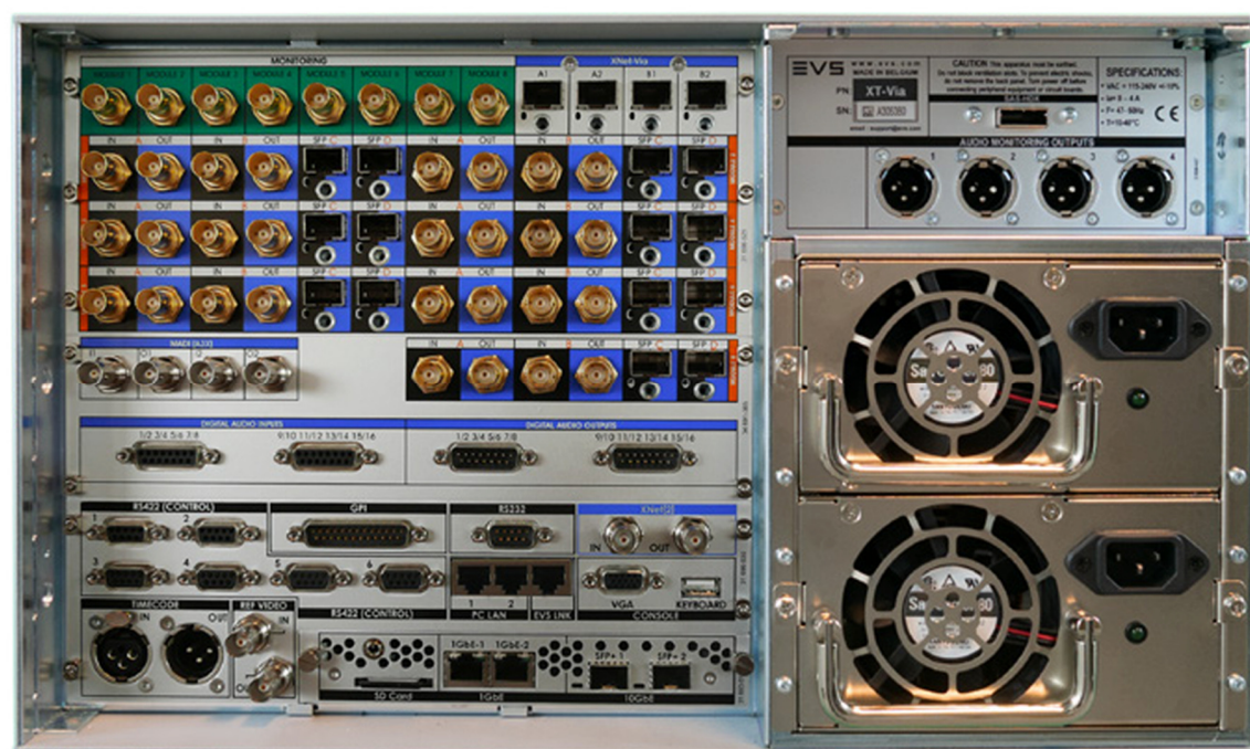
Gravador e reprodutor de áudio e vídeo – EVS XT-VIA – vista traseira (imagem ilustrativa com todos os opcionais inclusos)
