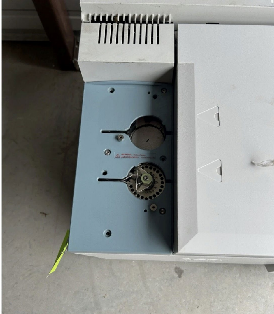
Figura 3 – Detector FID – vista superior (posição no GC).
