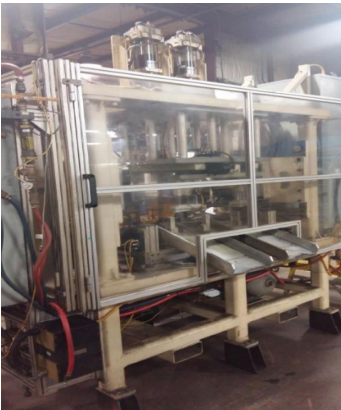
Foto 01 – Visão frontal da combinação de máquinas para soldar por resistência elétrica tipo ponto
