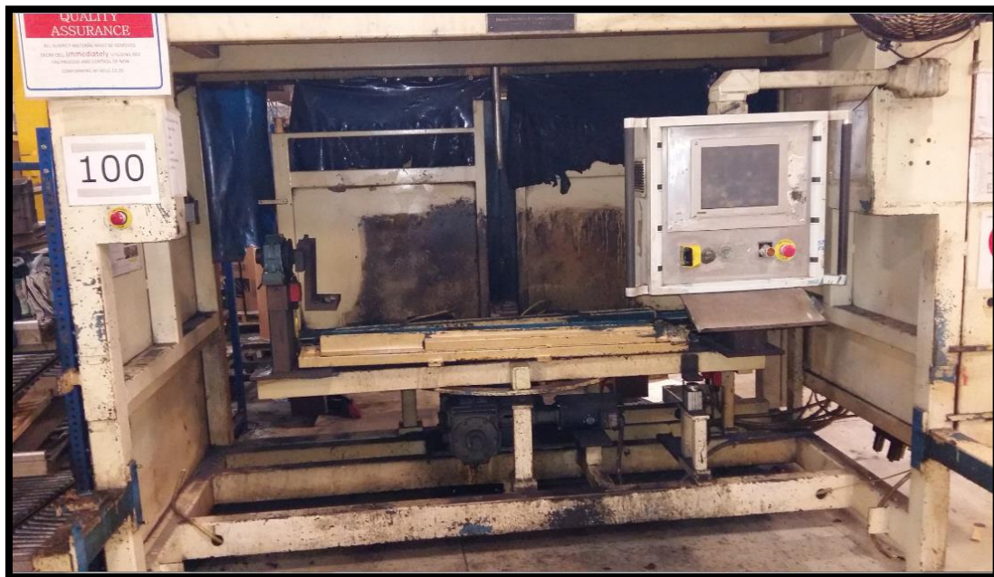
Foto 01 – Visão frontal corpo principal para recebimento das peças, com acesso às mesas giratórias e posicionadores com giro horizontal. Tochas de Solda acopladas à célula.
