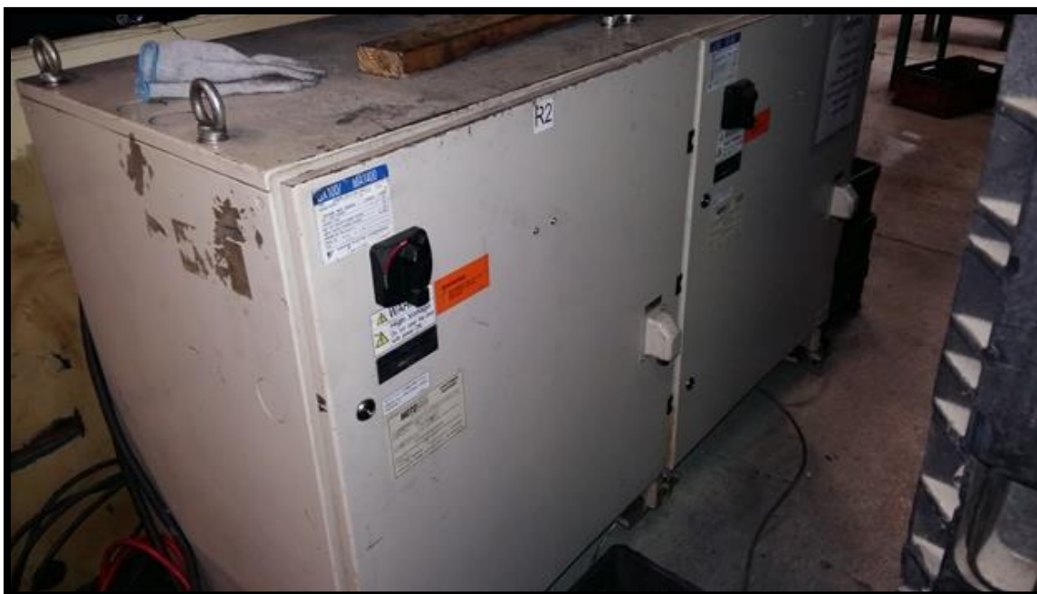
Foto 03 – Vista do controlador de sistema de solda eletrônica (CNC)
