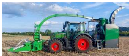
Dispositivo de pesagem de amostras Zurn 700
