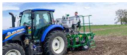
ZÜRN D82-AXL Parzellen-Sämaschine für Direktsaat
