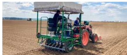
ZÜRN D82 Parzellen-Sämaschine mit Bandkopf
