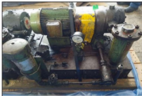
Unidade Hidráulica – disposta na parte traseira da máquina
