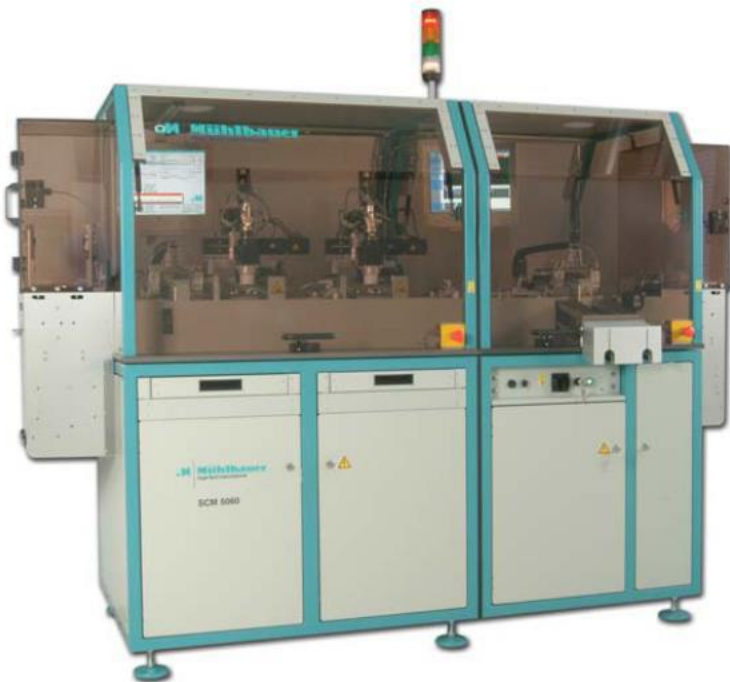
Vista geral da máquina automática para furar, modelo: SCM5060
