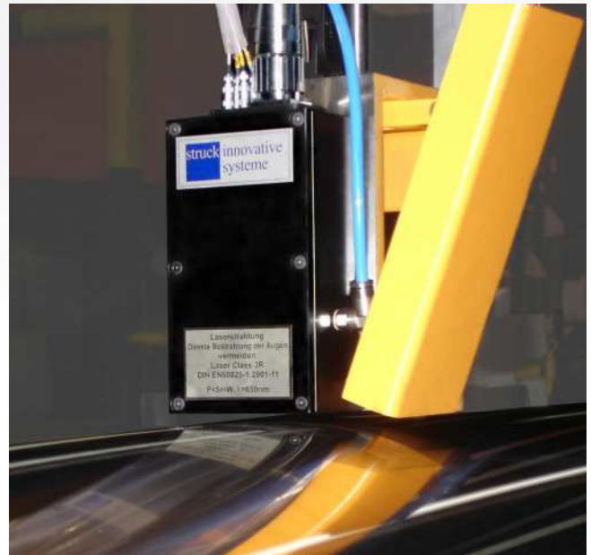
Sensor do RSIS durante Escaneamento de Inspeção da Superfície
