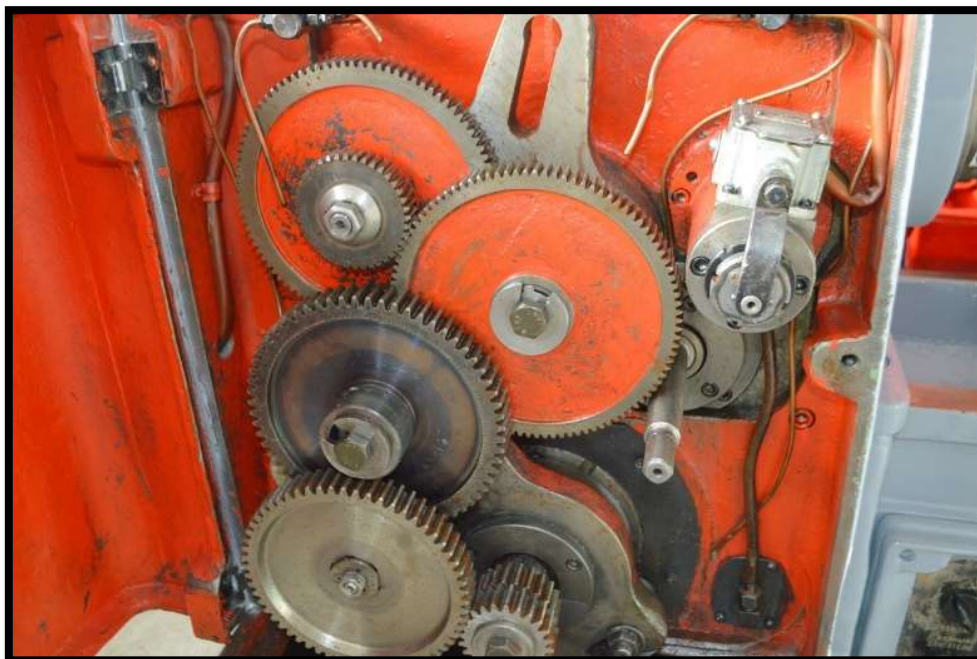
Detalhe da grade dos recâmbios do divisor dentes retos e avanços.
