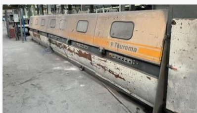
tampa de proteção em todos os blocos de tração.
