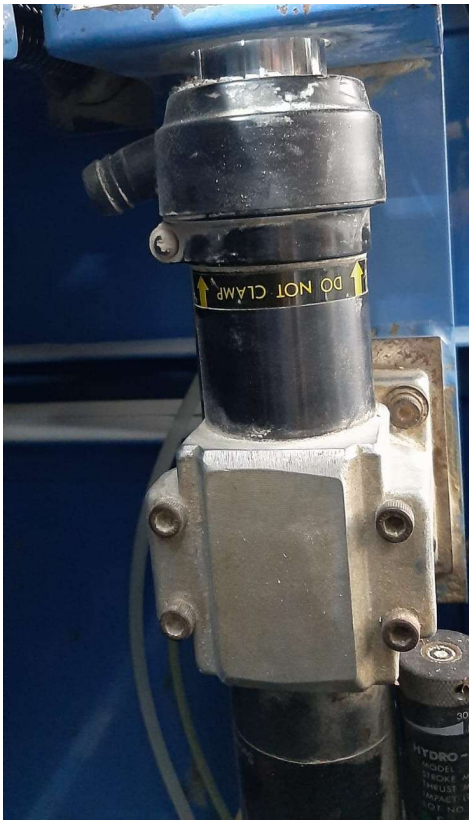
Foto ilustrativa de um dos motores pneumáticos (Spindles) de furação
