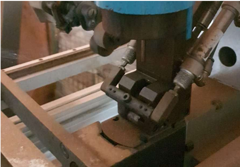
Foto ilustrativa Detalhe de um dos Inseriores de pinos pneumáticos
