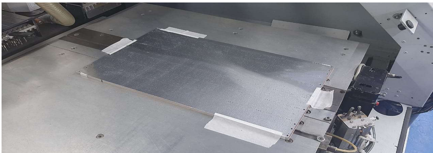
Stack fixado na máquina de furação
