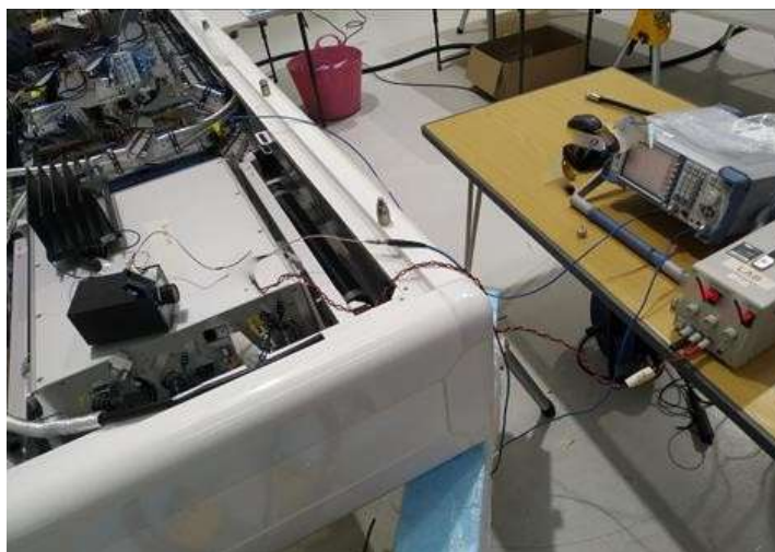
Figura 4. Foto do teste da cadeia de transmissão integrado.
