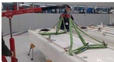
Figura 1. EQUIPAMENTO sendo preparado para ser içado e movimentado pelo Guincho Girafa (em vermelho) [56].
