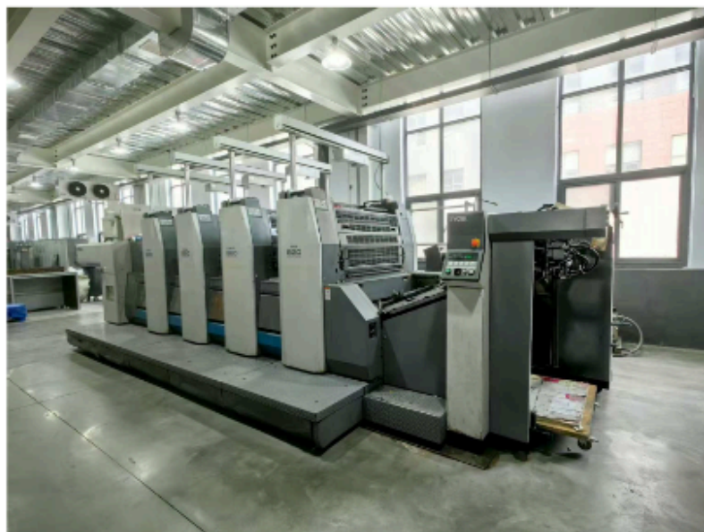
Figure 4: Vista frontal da Ryobi 924 com sistema de alimentação e torres de tinta
