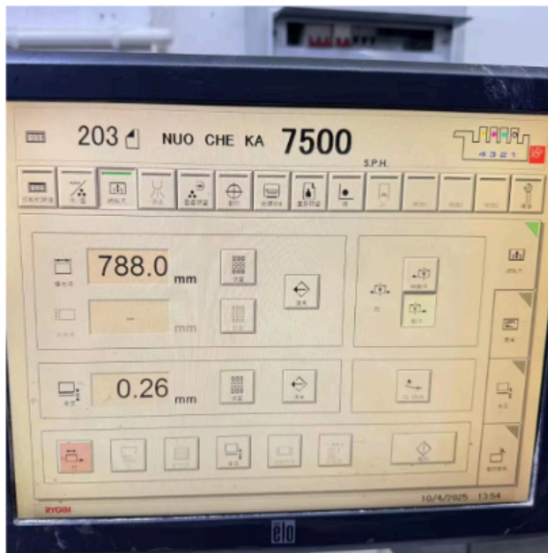
Figure 3: Painel de controle digital PCS-G mostrando parâmetros de impressão
