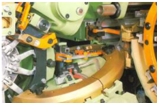
Figura 2 - Módulo de transferência de embalagem individual para formador de sticks
