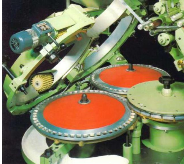
Figura 4 - Prato duplo de módulo de alimentação
