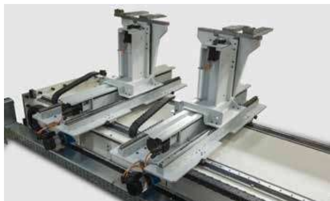
Backgauge modular (X1, R1, Z1 - X2, R2, Z2) para 500 T e 640 T no PPEB-8
