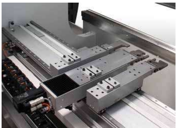
Dedo de backgauge adicional para medir tiras longas e pequenas
