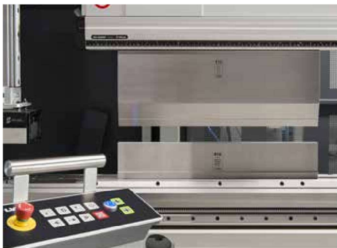
Fixação hidráulica de ação rápida no braço e na mesa
