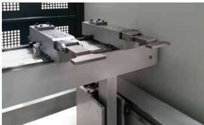
Backgauge de dois eixos padrão (X, R) com eixo Z manual em PPEB-4 e PPEB-5
