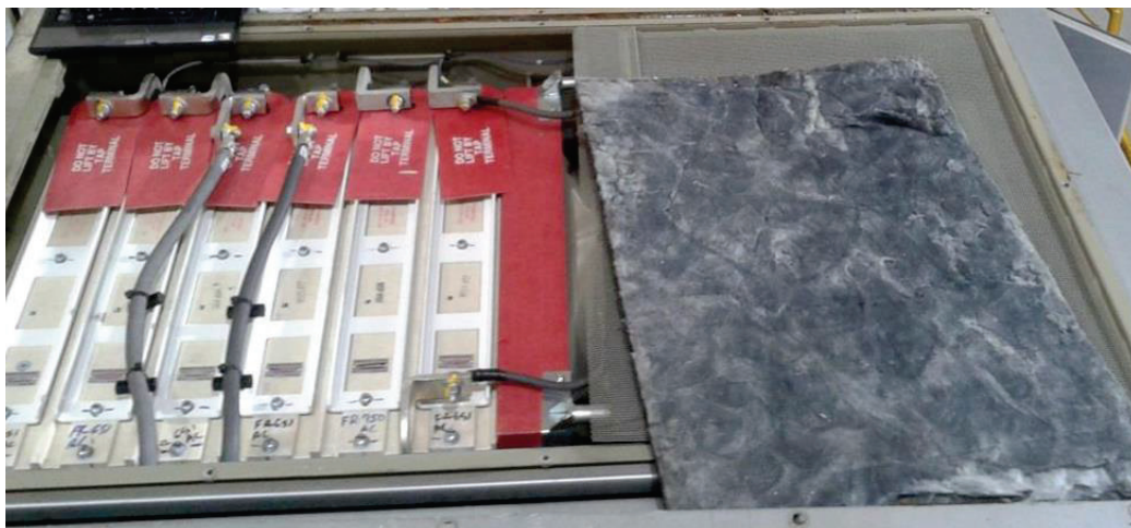
Montagem dos resistores na locomotiva, vista por cima
