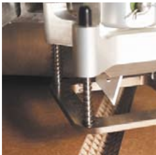
A roda de vinco pode ser facilmente trocada por uma ferramenta de corte com entalhe em V, para cortes em esquadria em papelão ondulado de parede tripla.
