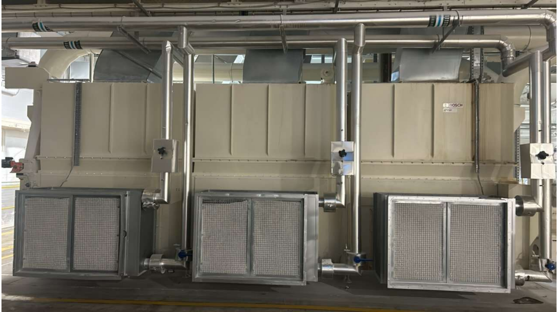
(01) uma unidade de resfriamento por leito fluidizado
