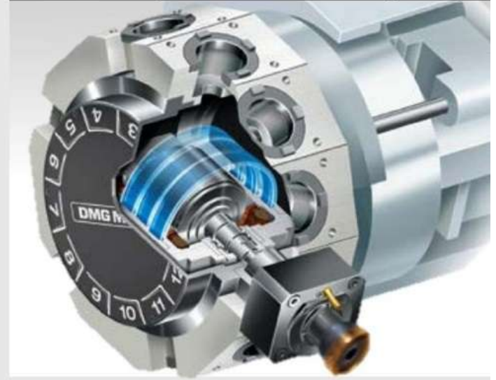
Circulação de refrigerante para peças fundidas BMT (torre de motor integrada)
