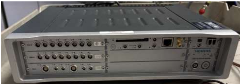
Exemplo de uma estrutura Simcenter SCADAS Recorder SCR205.
