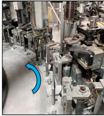
Berços de Mesa Rotativa para Manipulação entre Estações.
