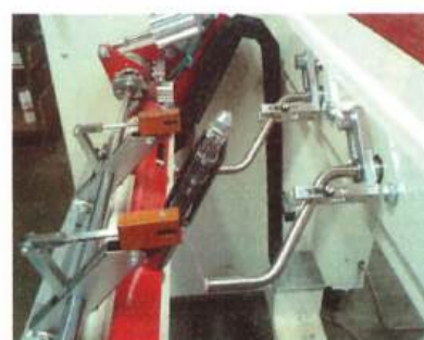
Cortador de fios com dispositivo de liberação automática da ponta do fio
