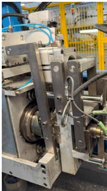
40004/12.8-2 Dispositivo de corte guilhotina/serra
