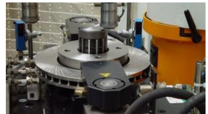
Mandril de fixação axial e mandril de lamelas
