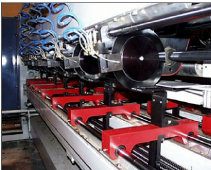
J - Estação de profundidade da vincagem
