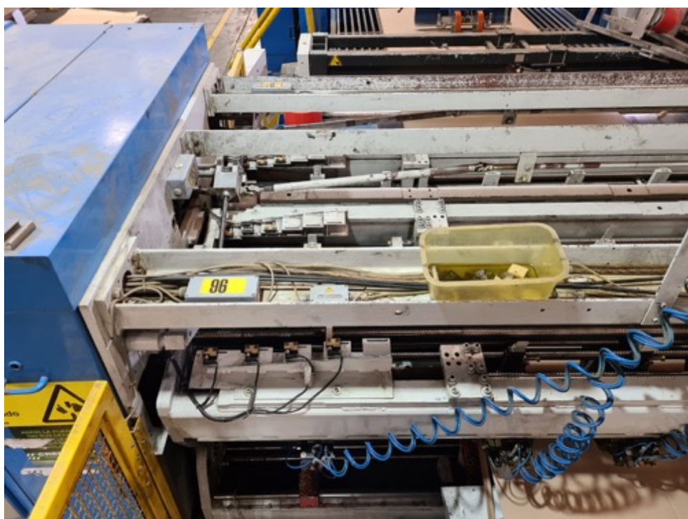
B – Vista Superior do Slitter mostrando os 2 conjuntos. Observar embaixo os suportes arrastadores de faca e vinco.
