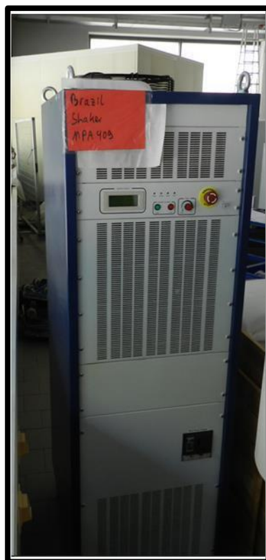
Imagem 3: vista geral do amplificador de potência desmontado
