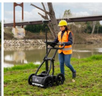
**6.7.2 A solução Ricitec Geo: PROEX** - Kit sistema ótico ProEx; antenas blindadas 100-800 MHz; Mochila com monitor para PC; Carrinho para terrenos acidentados incluindo encoder; EMLID ReachRS2+ e RS3 RTK GNSS (GNSS integrado);
