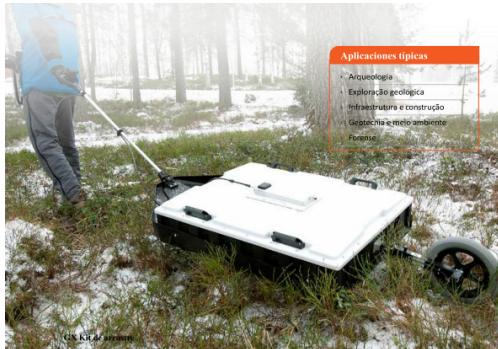
6.7.4 A solução **SOLOTEST: PROCEQ GS8000** - Gorrador utilizado para diversos tipos de investigação e avaliação subterrânea com sistema de geolocalização.
