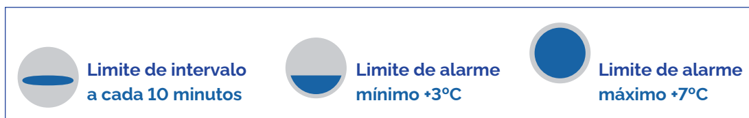
FIGURA 8 Parâmetros-limite que devem ser definidos em um datalogger
