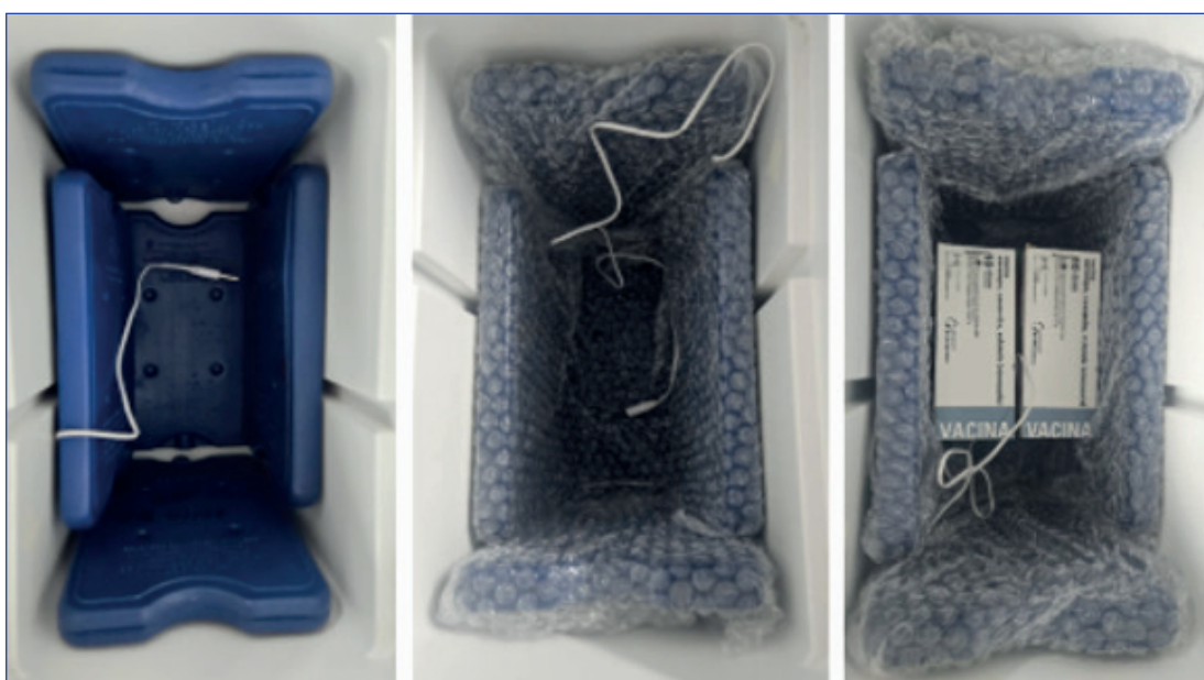
FIGURA 6 Modelo de organização das bobinas e do termômetro dentro da caixa térmica
