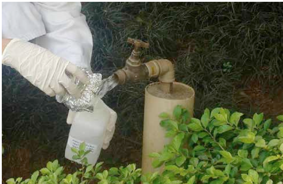
Figura 4: Coleta de amostra na torneira do jardim, após hidrômetro
