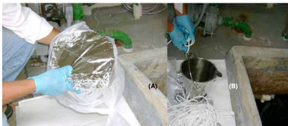
Figura 6: Coleta de amostras em reservatório com balde e corda: (A) balde, (B) balde e corda procedimento de coleta
