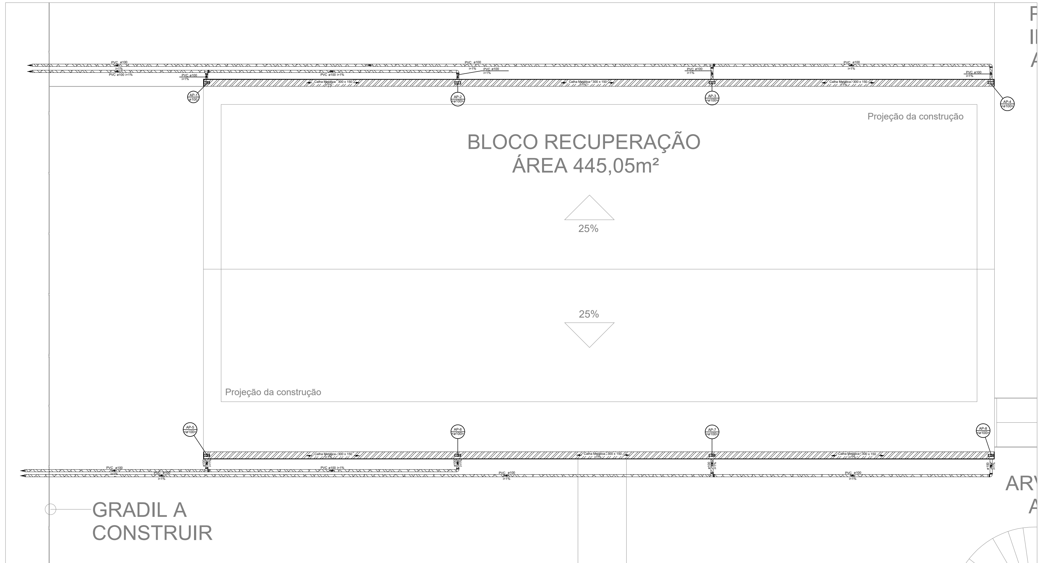
DETALHAMENTO ESGOTAMENTO PLUVIAL - BLOCO DE RECUPERAÇÃO ESC - 1/100
