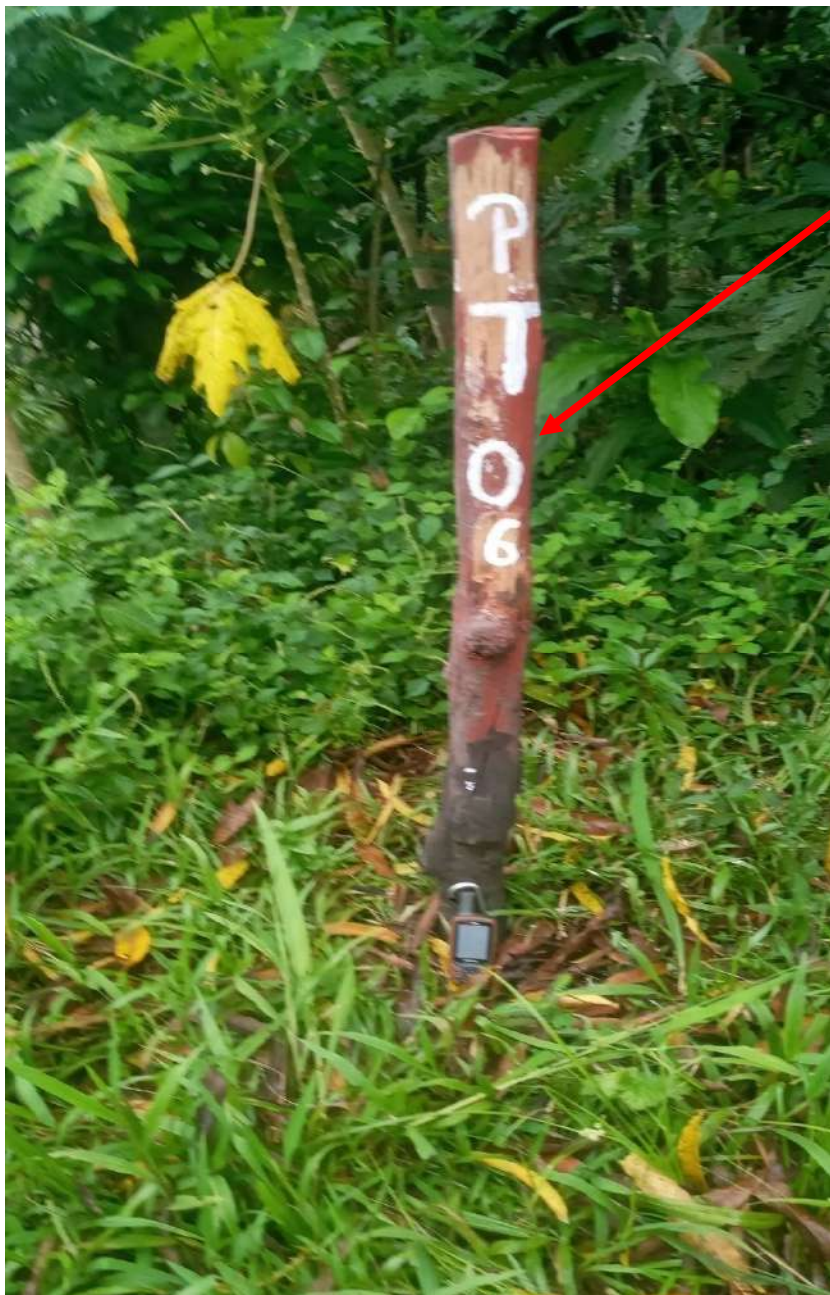
Foto 12 – A seta indica o piquete (a estaca) do Ponto p/a Construção do Poço nº 06 - SAA de Comunidade Campo Alegre - SPO - AM.
