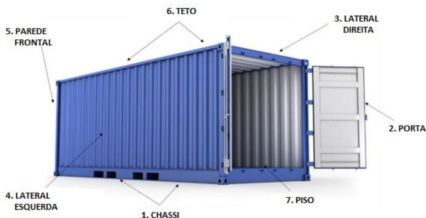
Fig. 24 – Inspeção dos sete pontos dos contêineres.
