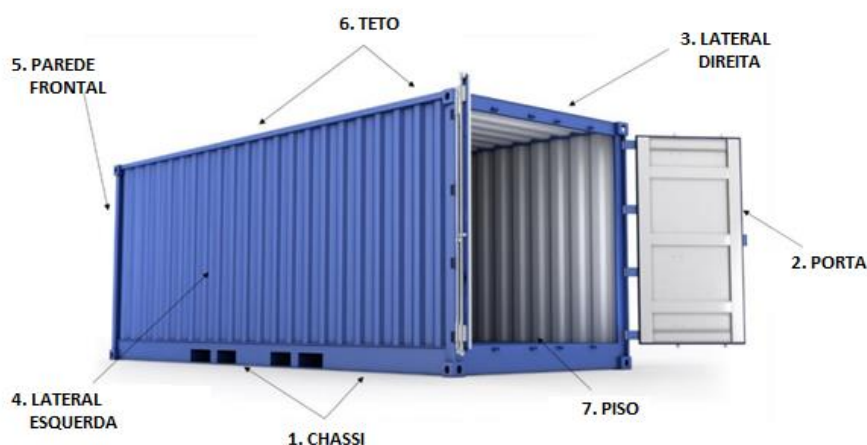
Fig. 21 – Inspeção dos sete pontos dos contêineres.
