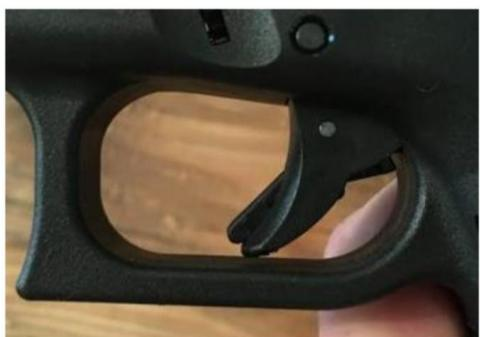
Pela imagem, facilmente se verifica que a "trava no gatilho" (comercialmente chamada pela Glock de "Trigger Safety"), na realidade, trata-se também de um tipo de "trava externa", já que é uma trava claramente visível e instalada na parte externa da arma.
