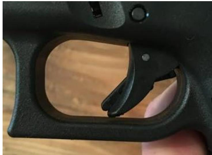
Pela imagem, facilmente se verifica que a “trava no gatilho” (comercialmente chamada pela Glock de “*Trigger Safety*”), na realidade, trata-se também de um tipo de “trava externa”, já que é uma trava claramente visível e instalada na parte externa da arma.
