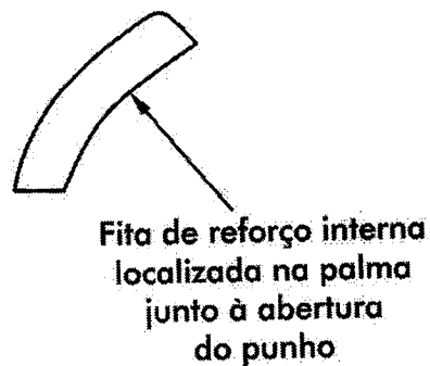
Figura 12 - Desenho técnico da fita interna de reforço da abertura do punho
