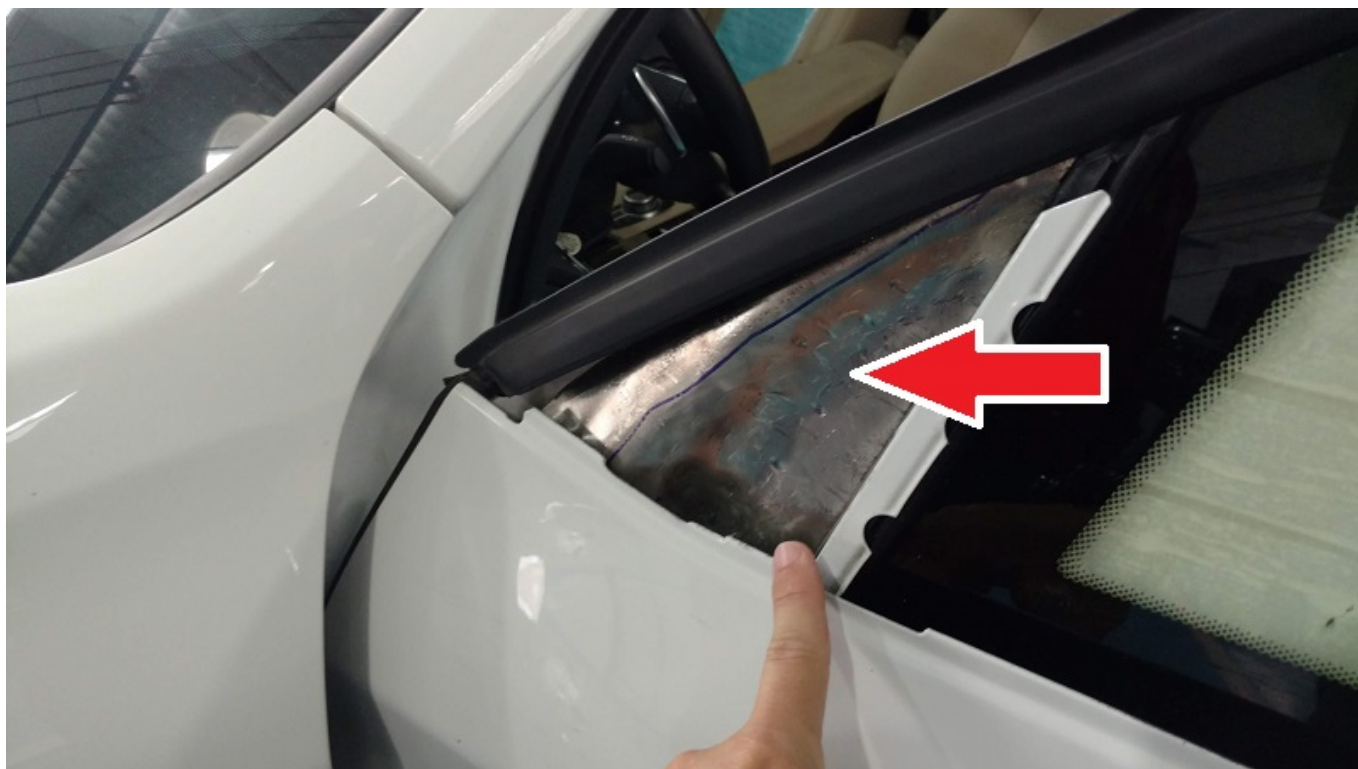
Figura 11 - Chapa de aço inox aplicada na região do retrovisor externo
