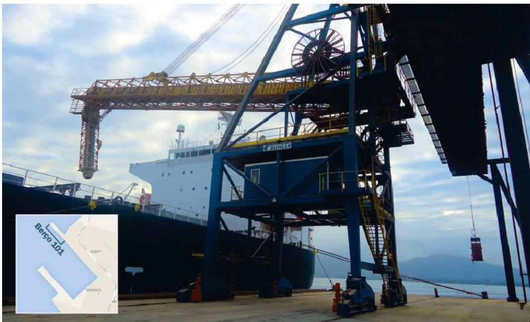
Figura 12 – *Shiploaders* posicionados para carregamento de navio no Berço 101
