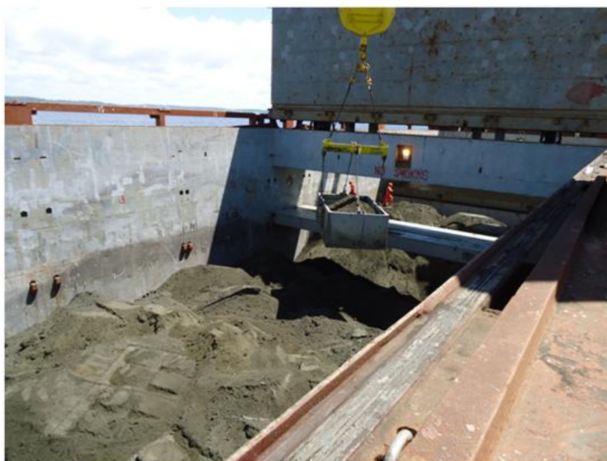
Figura 83. Descarga do Concentrado de Níquel no Porão do Navio Fonte: CODEBA
