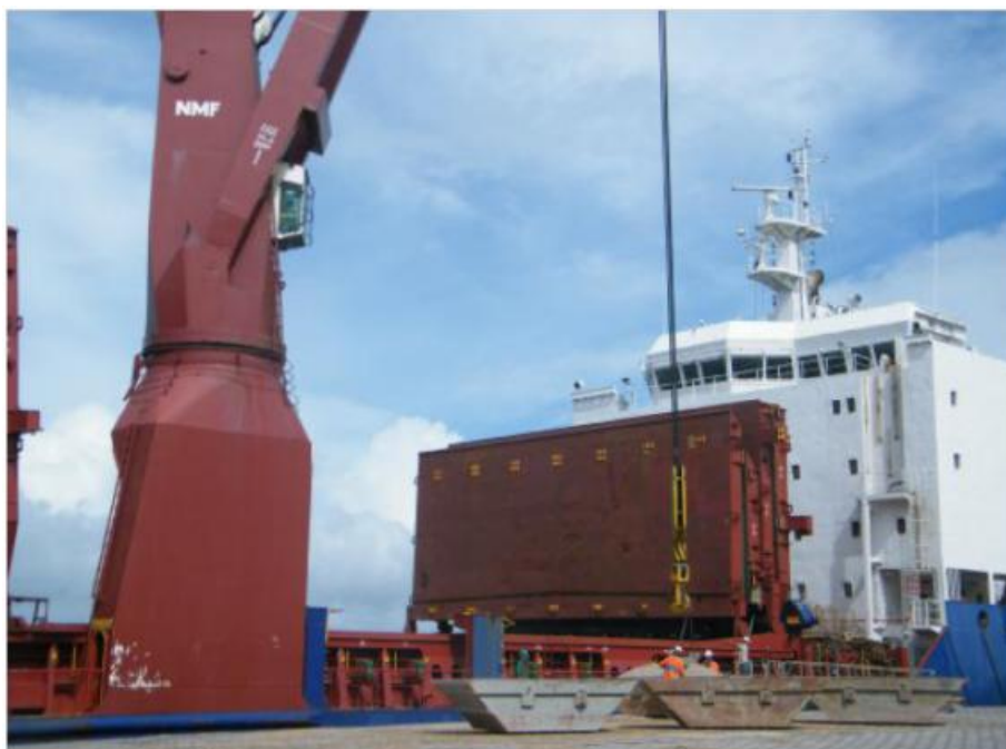
Figura 78. Preparo da Caçamba com Óxido de Magnésio para Içamento pelo Guindaste de Bordo Fonte: CODEBA
