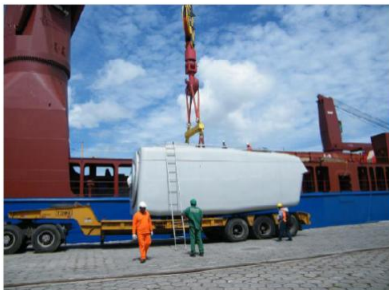
Figura 88. Desembarque de Gerador Eólico por Guindastes de Bordo para Carreta para Transportes Especiais
