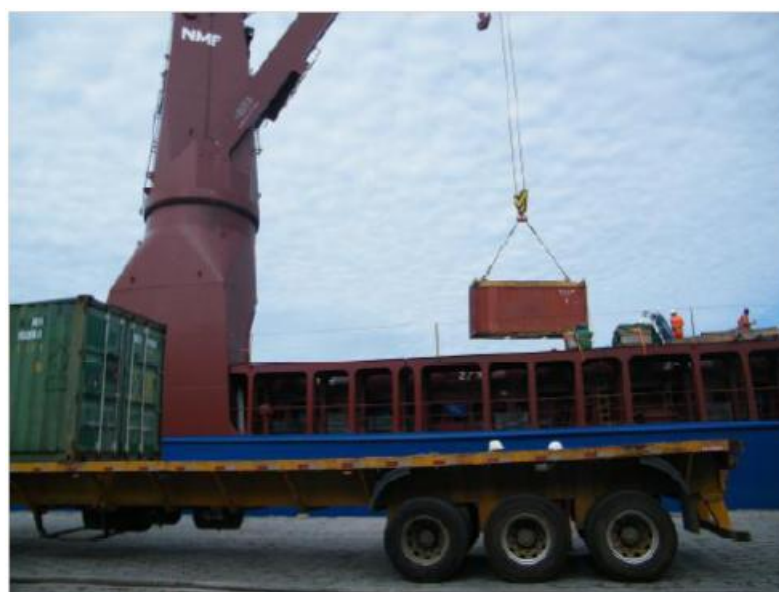
Figura 89. Desembarque Equipamentos para Parques Eólicos em Contêineres por Guindastes de Bordo
