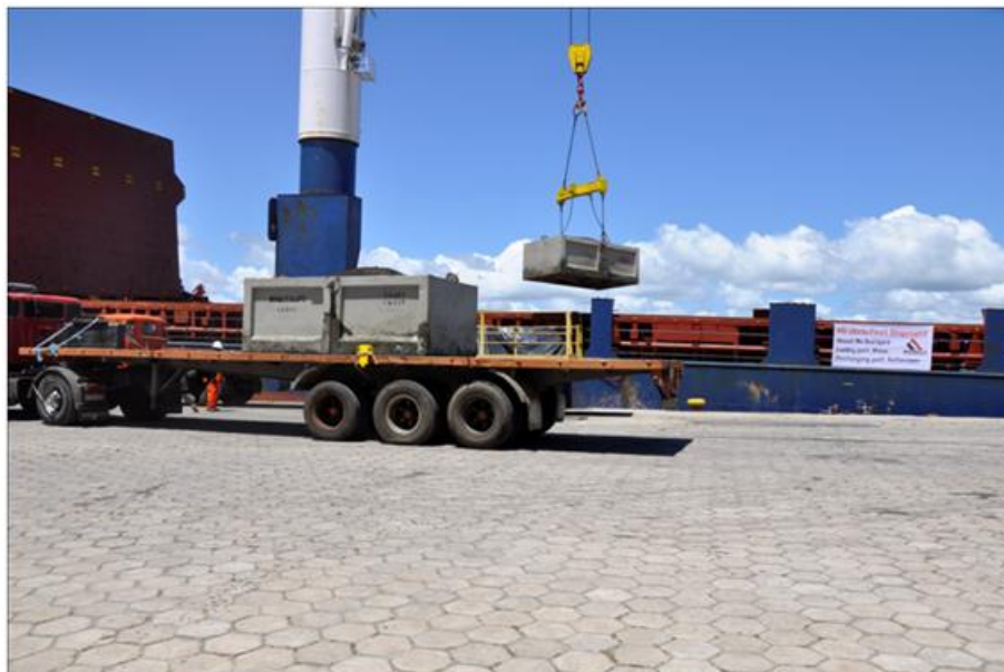
Figura 82. Içamento de Caçamba com Concentrado de Níquel pelo Guindaste de Bordo Fonte: CODEBA
