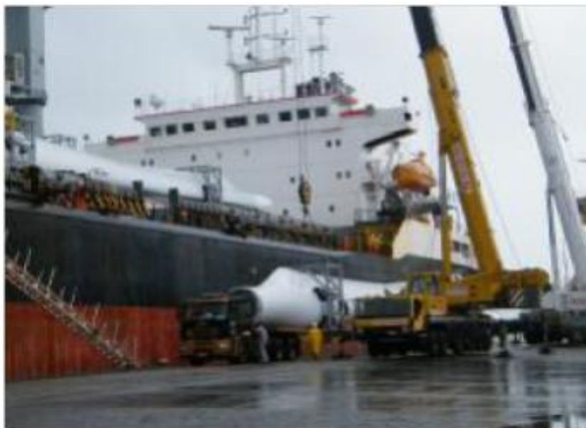
Figura 86. Descarga de Pás Eólicas por Guindaste Montado sobre Carroceria Diretamente para Carreta para Transportes Especiais
