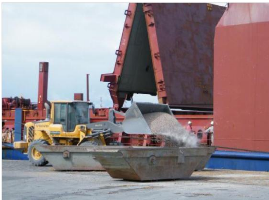
Figura 77. Enchimento de Caçamba com Óxido de Magnésio para Embarque em Navio Fonte: CODEBA
