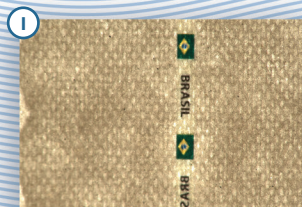
Fio de segurança luminescente UV-sensitive security thread
