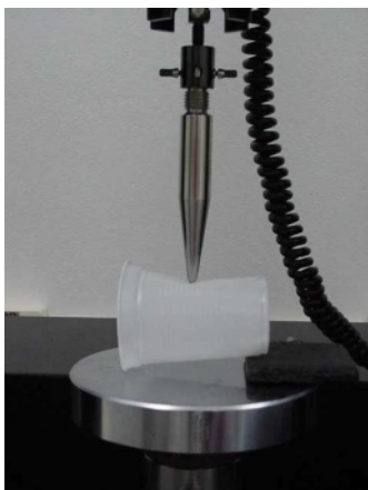
Figura 2 - Ilustração do posicionamento do copo para o ensaio de resistência à compressão lateral
