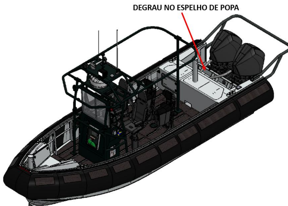
Figura 2: representação da embarcação com o degrau no espelho de popa.
