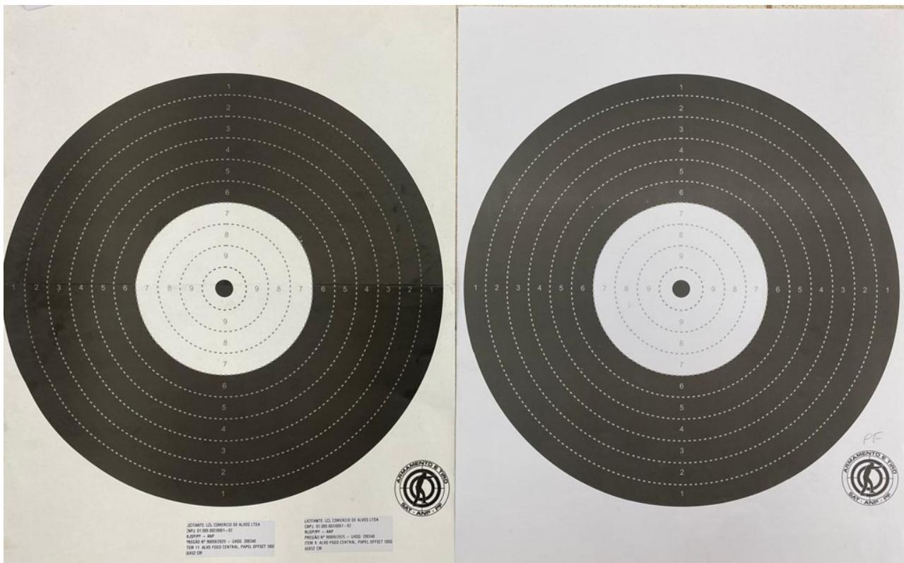
Verifica-se, baseado no alvo da PF (alvo da direita), que o alvo do fornecedor (alvo da esquerda) tem qualidade de impressão inferior em comparação a última compra da PF. Solicita-se que melhore a qualidade da impressão, contraste de cor e pontilhado, além da verificação da especificação do papel (offset 180g).
