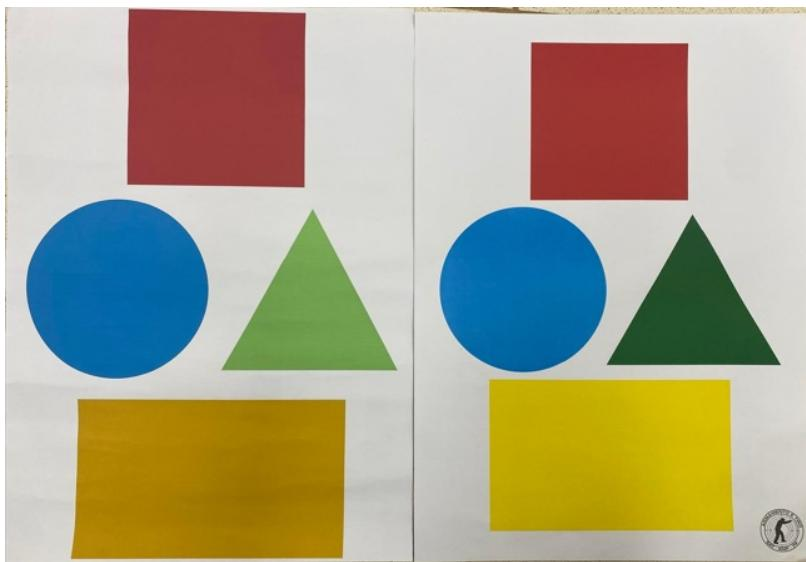
Verifica-se, baseado no alvo da PF (alvo da direita), que o alvo do fornecedor (alvo da esquerda) tem qualidade de impressão inferior em comparação a última compra da PF. Solicita-se que melhore a qualidade da impressão, contraste de cores e verificação da especificação do papel (offset 180g). INSERIR LOGOTIPO DO SAT/ANP (conforme alvo da direita).
