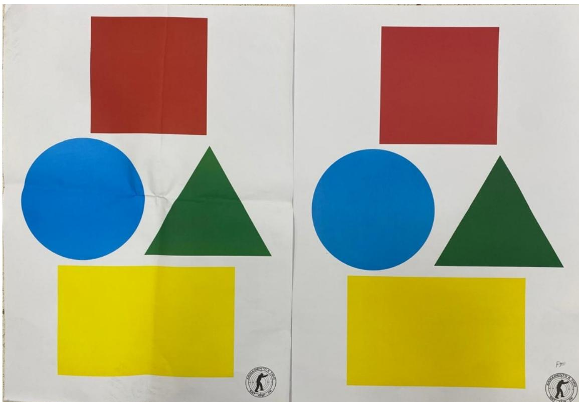
Verifica-se, baseado no alvo da PF (alvo da direita), que o alvo do fornecedor (alvo da esquerda) tem qualidade de impressão inferior em comparação a última compra da PF. Solicita-se que melhore a qualidade da impressão, contraste de cores , além da verificação da especificação do papel (offset 180g).
