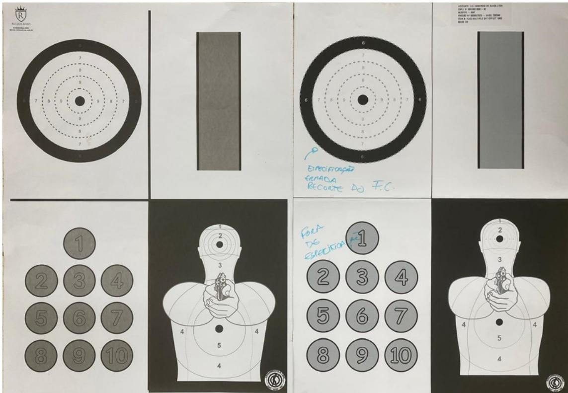
Os fornecedores deverão melhorar a qualidade da impressão (melhorar o contraste de cores), verificar a qualidade do papel OFFSET 180g. O círculo EXTERNO PRETO (1º alvo - fogo central) NÃO deve ter "pontilhado". As dimensões dos círculos deverão ser referentes aos DIÂMETROS EXTERNOS. A numeração deverá estar em "negrito" e "não" pode haver logomarca do fornecedor.
